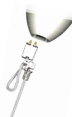
Trä in skruven, kontakt och överbliven sladd genom kåpan underifrån. Trä även genom ringen om denna ska användas för att få en större kåpa, eller då kontakten till taklampa sitter en bit ifrån där lampan ska hänga. Tryck då ut ett av de förberedda hålen, låt sladden löpa därigenom och placera ringen mot taket ovanpå kåpan.
