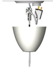
Häng upp skruven på takkroken och sätt i kontakten (eller kopplingsplinten). Se först till att takkroken sitter fast i taket och inte roterar. Häng på krogen, samla ihop den överblivna sladden och vira denna runt den övre delen av skruven/kroken (undvik dock själva gångan). Fäst med bifogad fästråd.
