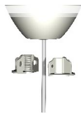
De två matchande bottendelarna läggs nu runt sladden, mot varandra, mellan kåpan och lampan. Tryck ihop dem ordentligt. För in botten i kåpan genom att passa i bottendelens "vingar" i spären inuti kåpan. Tryck in botten tills dess att ytan underrill blir helt plan.
