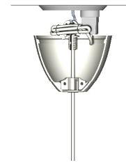
För lamptoppen uppåt mot skruven som hänger på krogen. När skruv och botten-delens "mutter" har hittat varandra inne i kåpan kan man börja skriva lamptoppen medslols uppåt. Skruva tills toppen når taket. För att hitta rätt kan du försiktigt dra i sladden nedåt, då kommer skruven automatiskt att vinklas rakt nedåt och därmed lätt hitta in i bottendelen.
